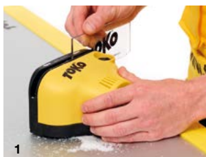
Abb. 1) Schärfen der Plexi Blade. Die Plexi Balde wird über den Scraper Sharpener gezogen; dieser ist für verschiedene Klingebreiten ausgerichtet.
