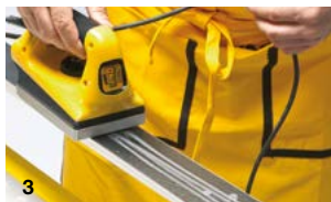
Abb. 3) Wax einbügeln. Das Waxron mit gleichmässigem Vorschub über die Gleitfläche stossen oder ziehen. Falls das Waxron nicht leicht gleitet, nochmals etwas Wax auftropfen.
